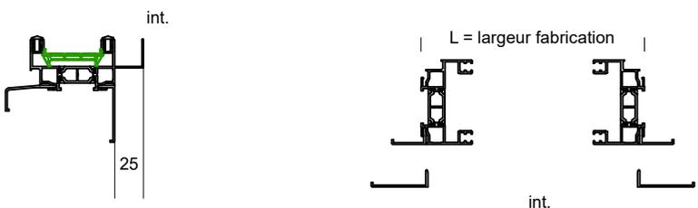
DORMANT POUR POSE EN NEUF DOUBLAGE DE 120, 140, 160, 180 et 200 mm
