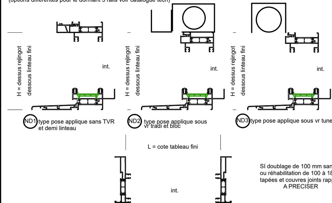
DORMANT POUR POSE APPLIQUE TUNEL OU FEUILLURE (options identiques pour le dormant 3 rails)
